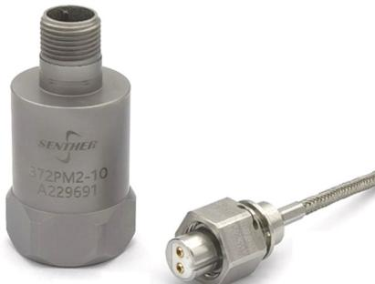
372PM2系列产品是一款耐高温的压电加速度传感器，其特点是采用压缩模式的陶瓷晶体为敏感元件，具有高分辨率输出信号的特性。此加速度传感器基于压电陶瓷的特性通过低噪声线缆输出电荷信号，信号地与外壳隔离。外壳采用高温合金，通过激光焊接工艺实现产品的密封性；输出连接头采用微型玻璃绝缘连接器以满足不同环境下使用时输出的稳定性。372PM2产品底部提供1/4-28的螺纹孔将加速度传感器固定于被测对象上。372PM2系列加速度传感器具有宽频带响应和耐高温的特性，所以适用于在高温环境下测量动态加速度及振动的场合。另外，森瑟科技还提供与接头配套的线缆，型号17P-L可选，具体可参见配件表格。
